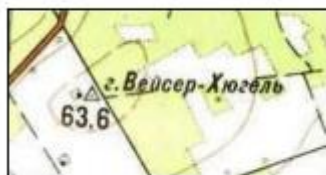
Рисунок 4 – Обозначение точки опорной сети
